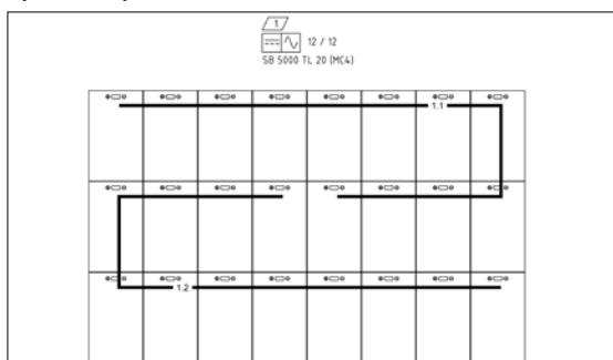
Rys. B 2-2 Przykład schematu okablowania DC
